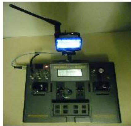
MC3030 avec module DHT DIY Fr Sky au dos & son afficheur télémétrie
